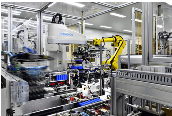
图为在山东电立得动力科技有限公司,工业机器人在生产锂电池。
